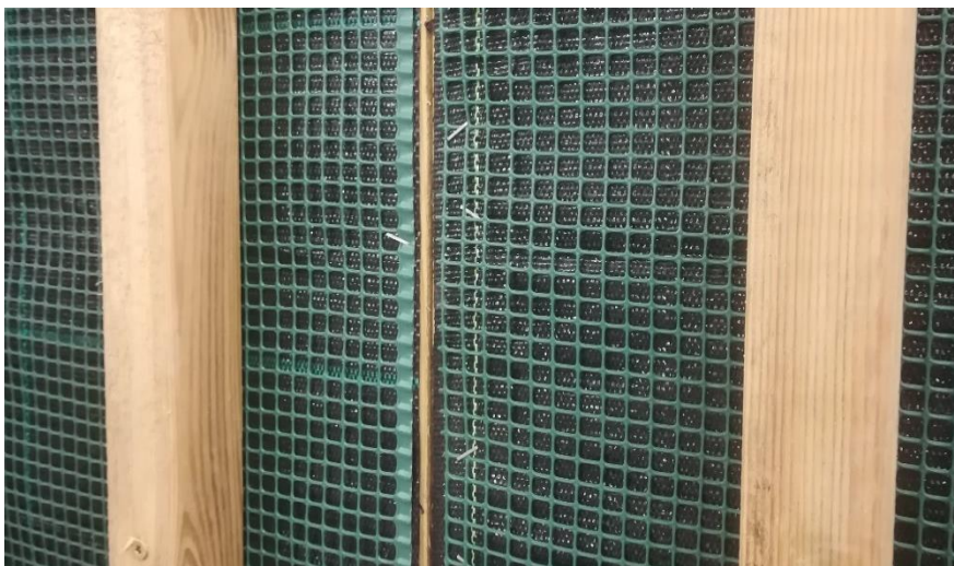
Bild 1 – Bullerskärm NB-WOOD-3A-04 sedd från sändarrum. Skarvar mellan provöppning och provobjekt tätades med lera
