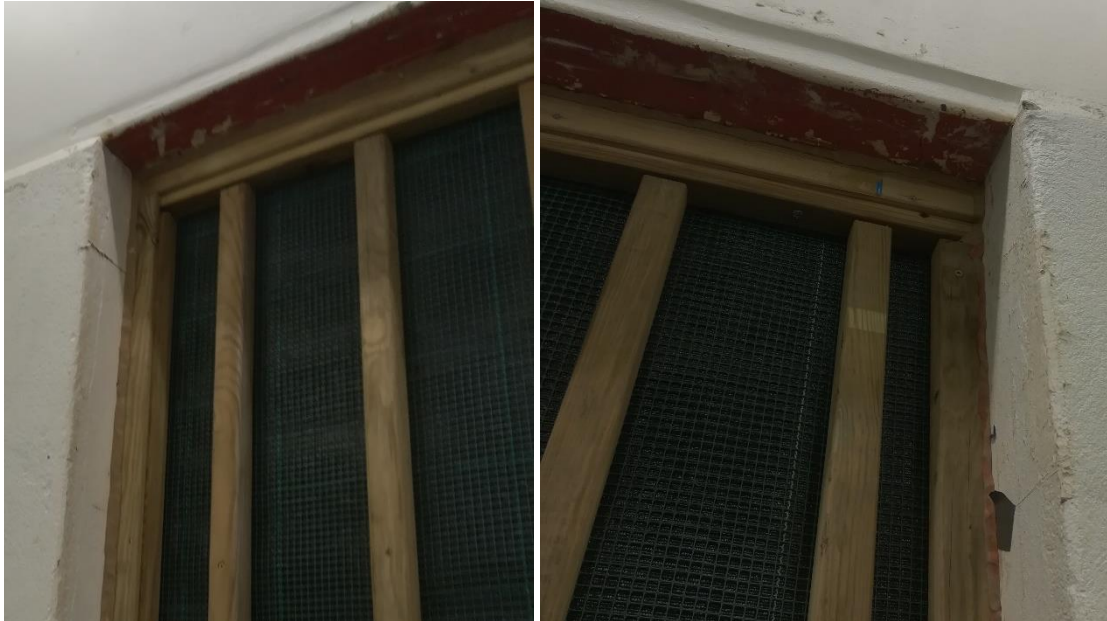
Bild 1 – Bullerskärm NB-WOOD-2A-05. Skarvar mellan provöppning och provobjekt tätade med lera
