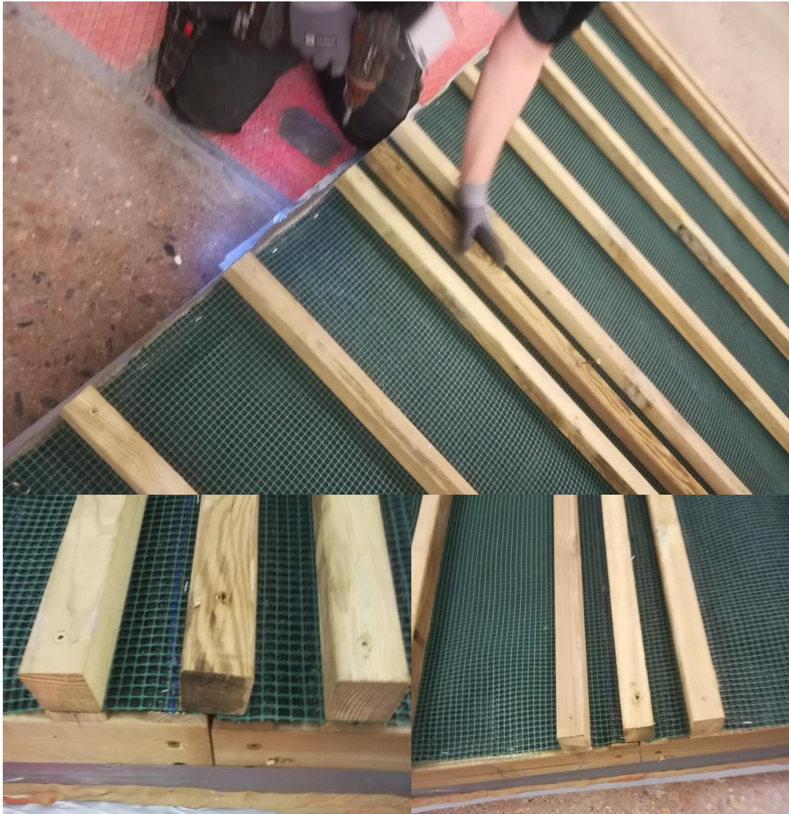
Bild 1 - Skärmen monterad i efterklangsrummet, med den absorberande ytan uppåt. De omgivande sidorna består av brädor, och är tätade mot golv med tejp och lera.
